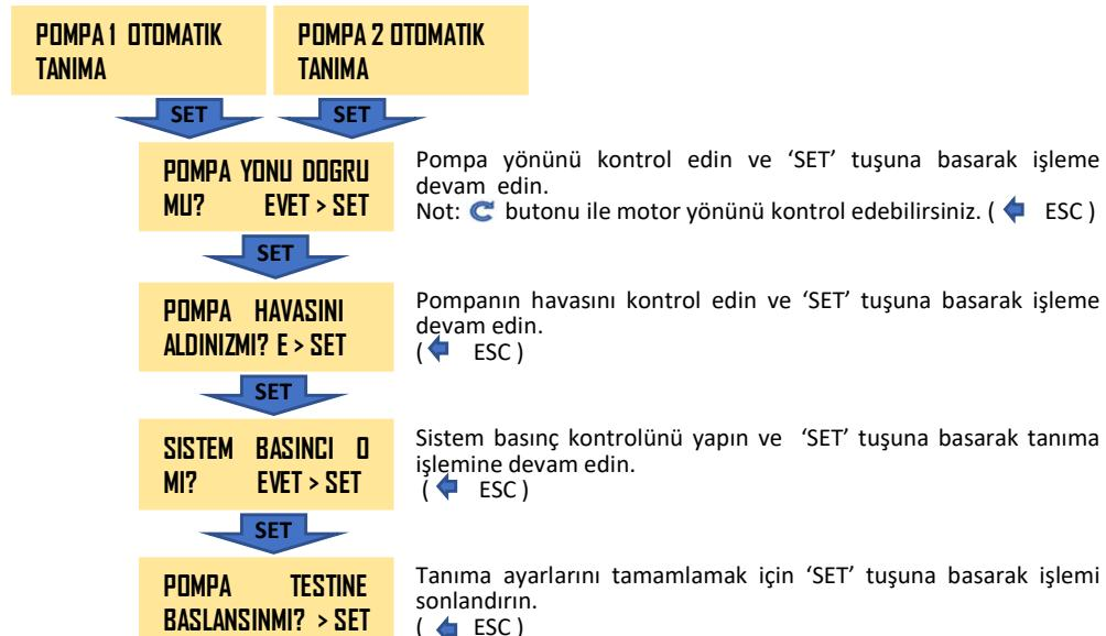
NOT: Test işlemi 3,5 sn. boyunca motorları çalıştıracak ve sistem aşağıdaki yanıldardan birisini verecektir. Verilen yanıtla göre işlemlerinize devam edin.
