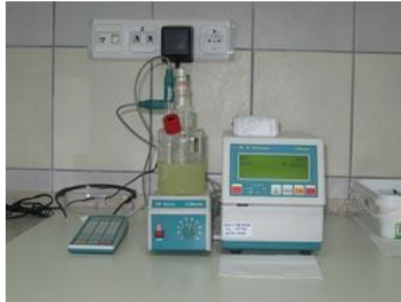
Resim 35- Trafo yağı test örneği
